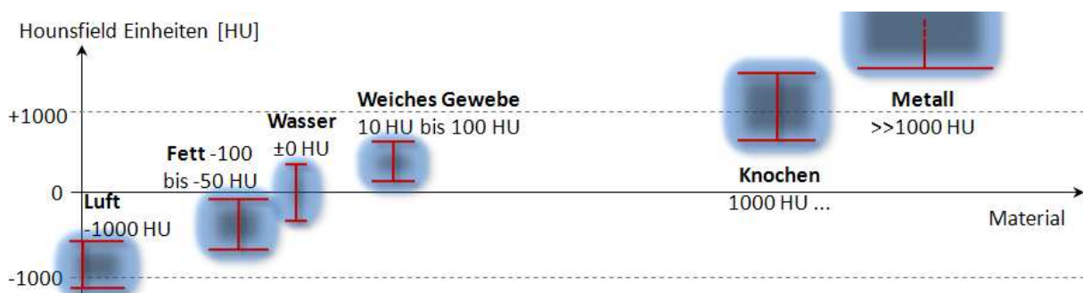
Abb. 2.2: Interpretation der Voxelwerte einer CT-Aufnahme; Hounsfield Bereiche für unterschiedliche Materialien.
